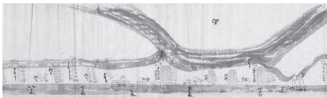
「西八幡堤絵図」(江戸～明治時代、山梨県立博物館蔵 [新海家文書]) に描かれた釜無川の堤防と牛柵類の設置状況
